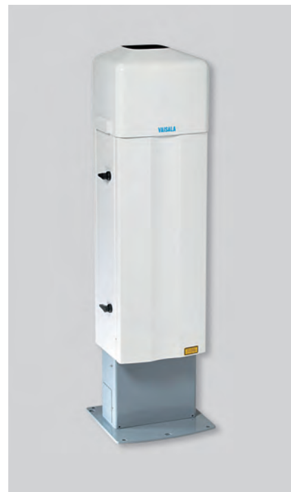
Облакомер CL31 фирмы Vaisala производит измерение высоты нижней границы облаков и вертикальной видимости при любой погоде – хорошей или плохой.
